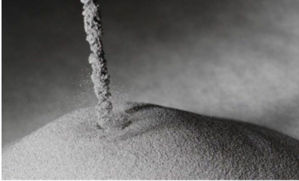
Image : Poudre métallique de titane de PyroGenèse produite par son système d'atomisation par plasma NexGen MC .
