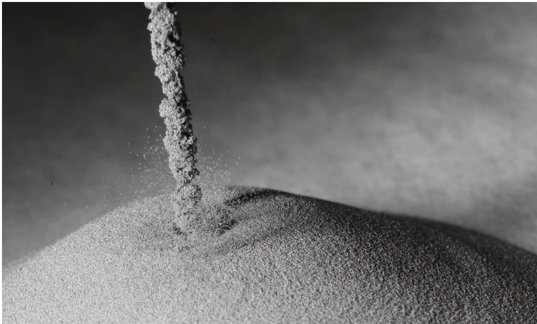
Image : Poudre de titane métallique de PyroGenèse produite au moyen de son système d'atomisation au plasma NexGen MC .
